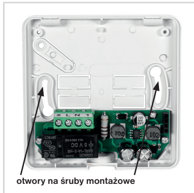
Rys.4 Połączyć obudowę i zabezpieczyć śrubą łącznikową.
